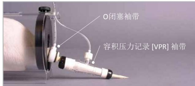
容积压力记录 [VPR] 是一种准确的、临床验证的、获得专利的方法来测量小鼠的血压和大鼠通过使用容积压力记录传感器和闭塞尾袖确定尾部血容量。
